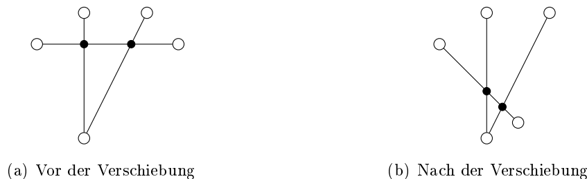
Abbildung 3.12: Harte Begradigung von Kreuzungsknoten: Beim Verschieben der Endknoten wandern die Kreuzungsknoten mit.
